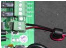
Ferrithülse auf dem Stromversorgungskabel
