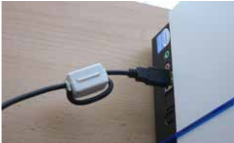
Klappkern auf dem USB-Kabel am Computer
