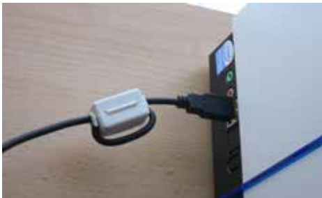
Klappkern auf dem USB-Kabel am Computer
